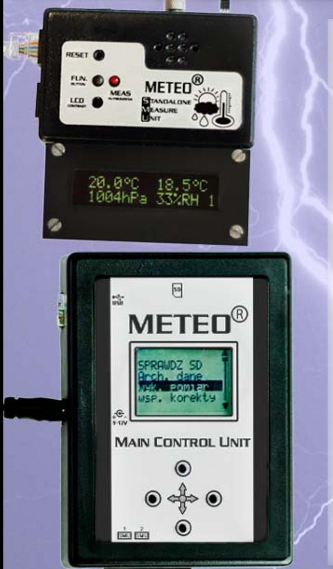
Celem projektu było wykonanie układu do monitoringu warunków środowiskowych w laboratorium. Układ miał zapewniać pomiary temperatury, wilgotności i ciśnienia, dysponować pamięcią nieulotną pomiarów (min.10000), zapewniać współpracę z komputerami PC.
