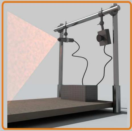
Celem projektu było stworzenie skanera 3D - urządzenia umożliwiającego automatyczne tworzenie wirtualnych, trójwymiarowych modeli rzeczywistych obiektów. Głównymi elementami urządzenia są kamera wraz z obiektywem, projektor linii laserowej oraz układ obracający skanowany obiekt.
